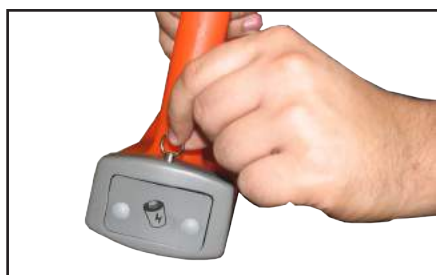
а) Выдвинуть фиксатор, освободить батарейный отсек
